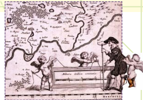
▲ Bressia vulgo Bresse (détail), par Guiljelmus Blauw. Amsterdam, XVII e siècle. Papier, 39 x 49 cm. La triangulation requiert d'une part une mesure précise de la base, à l'aide de toises ou d'une chaîne, et des instruments de visée permettant d'effectuer des mesures d'angles exactes sur des distances relativement importantes, comme le quart de cercle représenté ici. Arch. dép. Meurthe-et-Moselle, 1 Fi 238.
