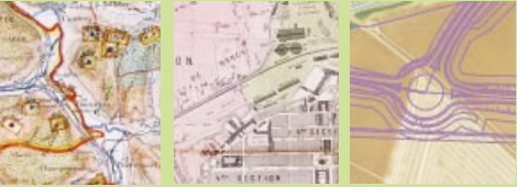
Projet du contournement routier de Briey. 2005. Les systèmes d'information géographique (S.I.G.) permettent de représenter les données par des couches superposables. Cette carte réalisée dans le cadre de la réalisation du contournement routier de Briey présente ainsi, sur fond d'orthophotographie, le parcellaire cadastral, les cours d'eau et le tracé du projet. Département de Meurthe-et-Moselle, direction de l'aménagement des territoires.
