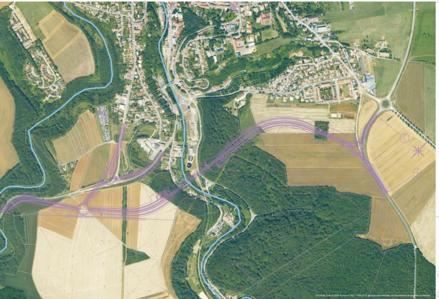
Projet du contournement routier de Briey. 2005. Les systèmes d'information géographique (S.I.G.) permettent de représenter les données par des couches superposables. Cette carte réalisée dans le cadre de la réalisation du contournement routier de Briey présente ainsi, sur fond d'orthophotographie, le parcellaire cadastral, les cours d'eau et le tracé du projet. Département de Meurthe-et-Moselle, direction de l'aménagement des territoires.
