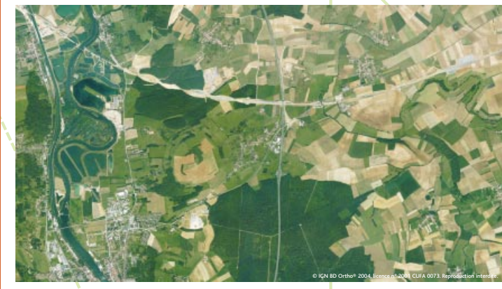
Orthophotographie du secteur de Pont-à-Mousson, Raucourt, Vandières. 2004. Les prises de vue aériennes sont redressées en corrigeant les déformations dues à l'inclinaison des axes de prise de vue, à la distorsion de l'objectif et au relief, afin d'obtenir une orthophotographie : l'image du terrain obtenue est telle qu'elle résulterait d'une projection orthogonale verticale. Département de Meurthe-et-Moselle, direction de l'aménagement des territoires.
