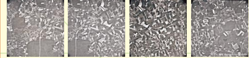
Mission photographique Nomeny/300. 1977. Tirage papier, 24 x 52,5 cm. Les photographies aériennes sont prises depuis un appareil dont l'altitude et la trajectoire sont minutieusement contrôlées, afin de limiter les déformations. On obtient ainsi une série de clichés pris à intervalles réguliers et qui se recoupent partiellement ; elle constitue le matériau pour la représentation cartographique du territoire. Arch. dép. Meurthe-et-Moselle, 1433 W.
